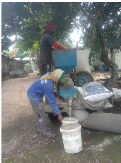
Gambar 1. Proses Penggilingan Pada ada Selep Padi Keliling
