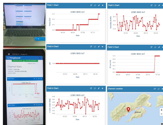
Gambar 1. Hasil Monitoring Sistem Peringatan Dini Gerakan Tanah Jeni Longsor. Bagian Kiri: Monitoring EWS dengan laptop dan smartphone. Bagian Kanan: tampilan web
